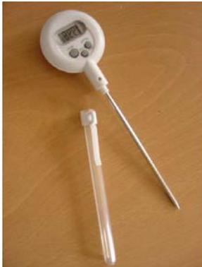
Termómetro digital com sonda de penetração em aço inox.
